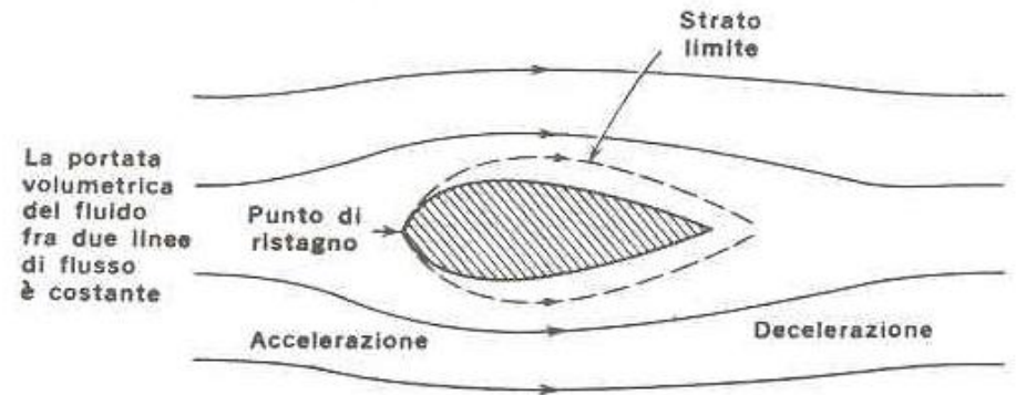
(a) Forma accordata con le linee di flusso: non si ha il distacco dello strato limite.
