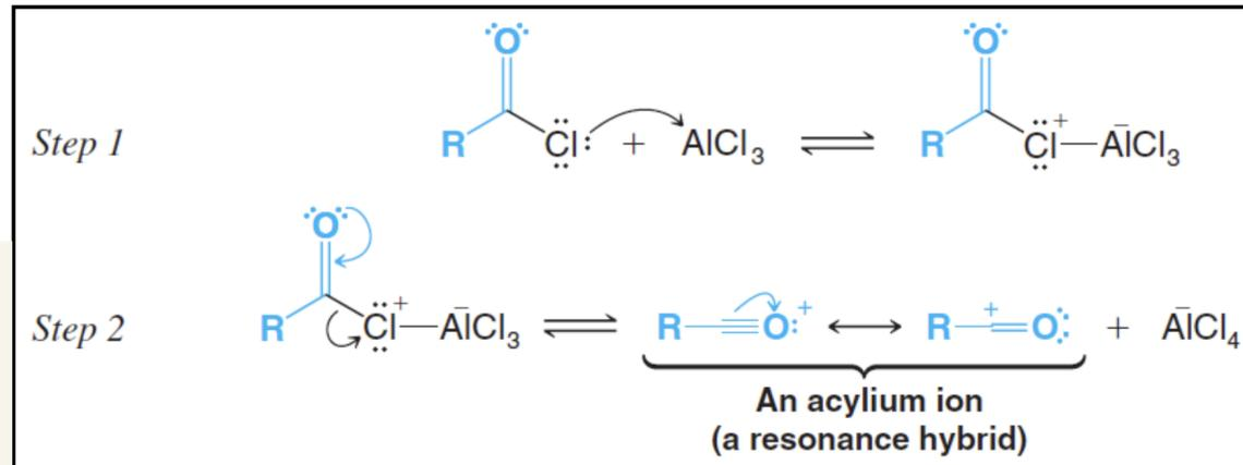
Poiché il prodotto di una reazione di acilazione di Friedel-Crafts contiene un gruppo carbonilico che può formare un complesso con l' $\text{AlCl}_3$ , l'acilazione di Friedel-Crafts deve essere condotta con più di un equivalente di  $\text{AlCl}_3$ . Quando la reazione è terminata, si aggiunge acqua alla miscela di reazione per liberare il prodotto dal complesso.
