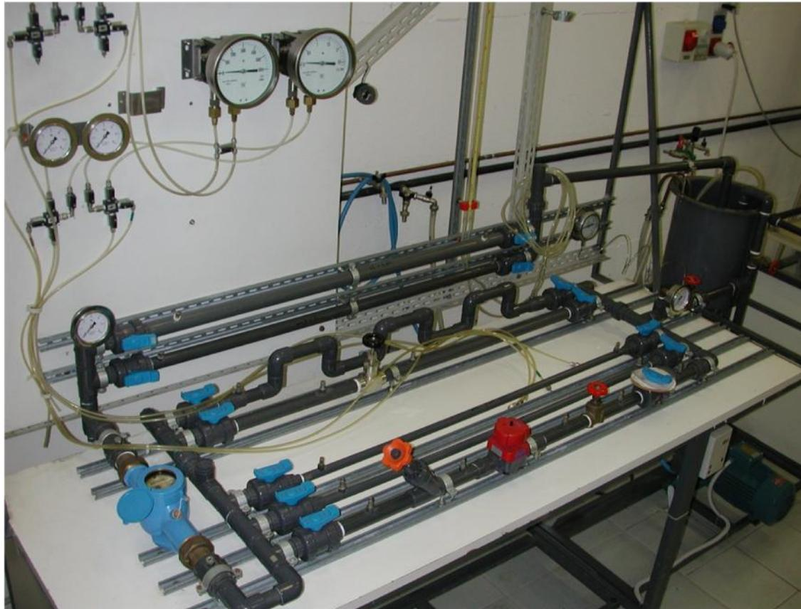
*Misure di pressione (assoluta, differenziale), portata, temperatura e determinazione delle perdite di carico in tubazioni ed accessori di linea.*
